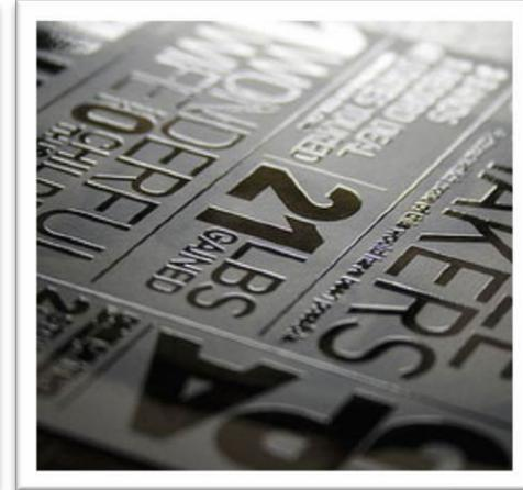
Bei der UV-Lacktechnologie wird der aufgetragene Lackfilm durch die Bestrahlung mit kurzwelligem, energiereichem UV-Licht ausgehärtet.
